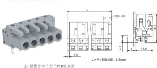
2-24通道针型连接器带弯型焊针
