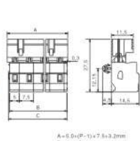
2-24通道针型连接器带销钉 (防错) KF475KG
